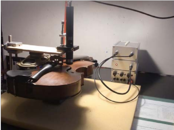
Abbildung 1 Foto der Anordnung. Links im Bild der Lautsprecher, er bestrahlt das auf der Seite des Kinnhalters befindliche f -Loch. Das Rauschsignal wird von den drei Geräten im Hintergrund erzeugt (in der Mitte der eigentliche Rauschgenerator, darüber ein in dB -Stufen einstellbarer Abschwächer und unten ein NF -Verstärker zur Anpassung an den Lautsprecher). Über dem zweiten f -Loch das (Elektret-)Mikrophon, dessen Ausgang mit der Soundkarte des PCs verbunden ist.
